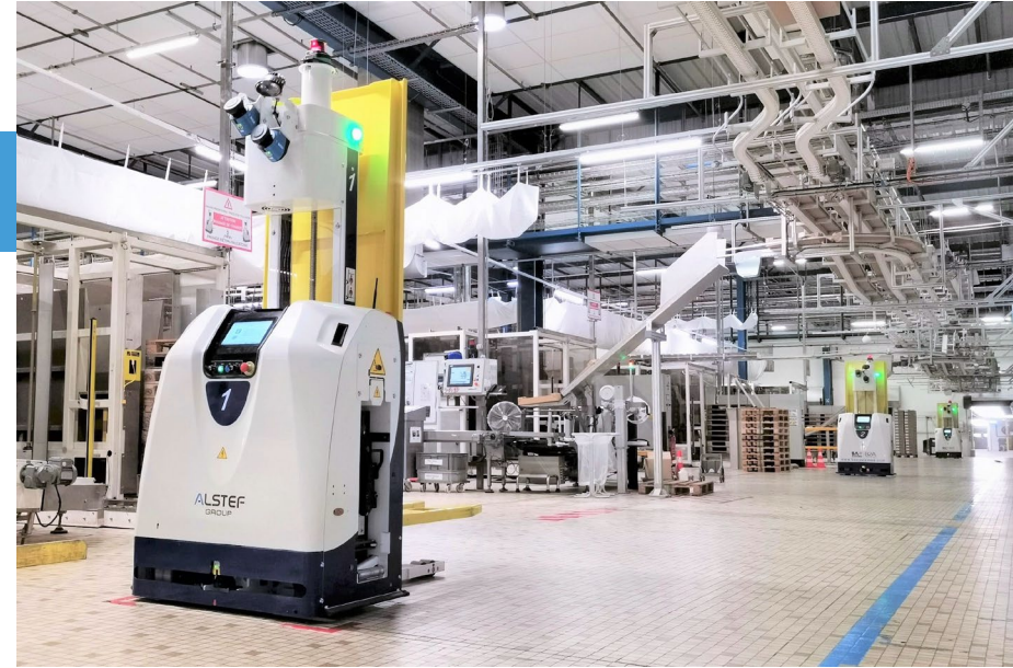
AGVs à fourches en interface avec les lignes de production
